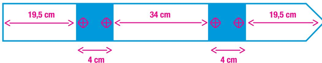
**Étape 3 :** Pré-percer légèrement les trous pour les vis à bois et fixer ensuite les sangles. Ne pas oublier de replier les sangles avant de visser pour la solidité.
